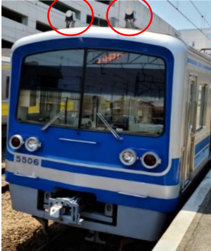
車上無線機アンテナ（赤丸部）
